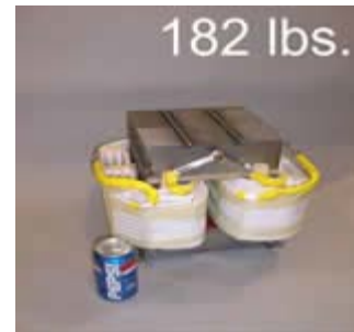
Transformer Rectifier Transformer
